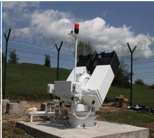
სურათი დნ-2 ჩეხური წარმოების ამინდის რადარი skySCANner
